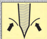
BORDE PULIDO CON HENDIDURA HOLLOW GROUND EDGE
